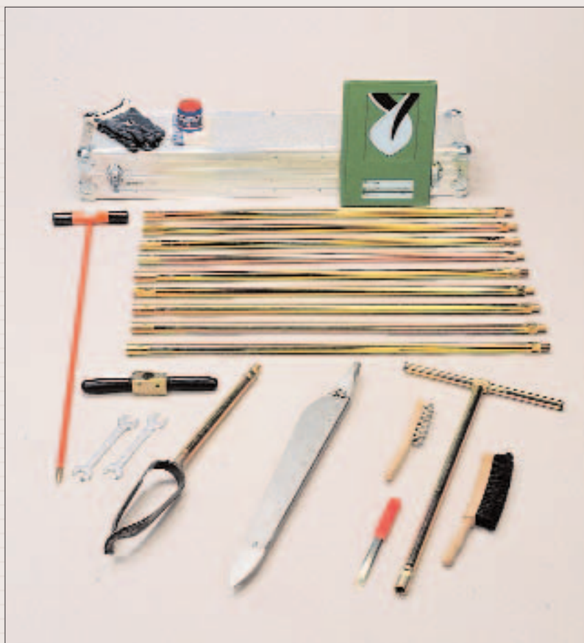
Ensemble complet de prélèvement d'échantillons de sédiments semi-remaniés
