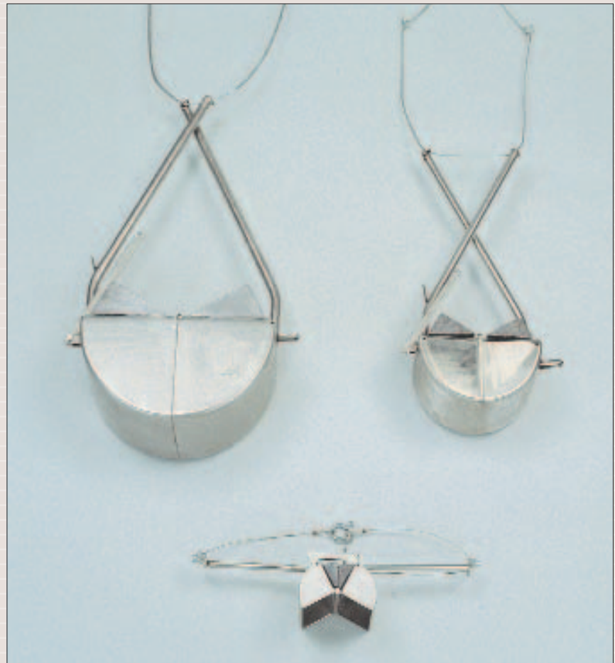
Préleveur benne type "Van Veen"
