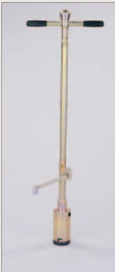
Tarière racinaire bipartite avec poignée à embout de frappe.
